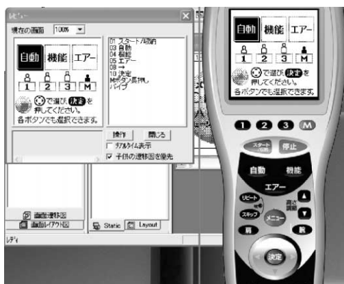
図4 バーチャル・ターゲットを用いたリモコン画面操作のシミュレーション
