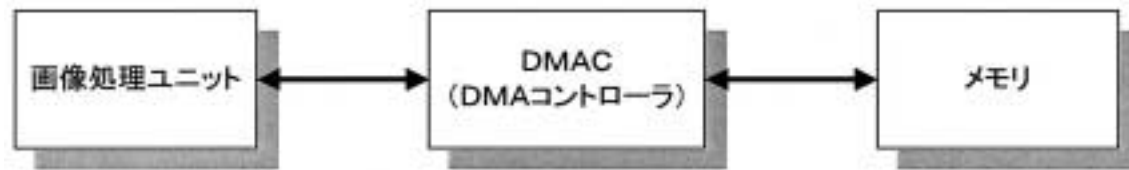
図1 画像処理ユニットとメモリ間でのデータ転送イメージ図
